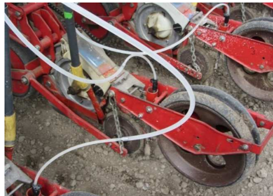
Foto 2. Zaaielement met zaaivoortoepassing voor vloeibare PK-meststoffen (foto: IRS).
