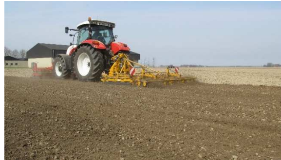
Zaaibedbereiding met tussendrukrollen tussen tractor en zaaibedbereider, zodat zaaibed egaal aangedrukt wordt.
