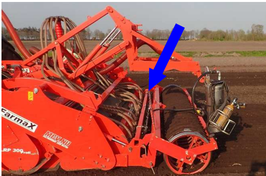
Toepassing van Bonalan op de spitmachine, door middel van spuitdoppen tussen de rotor en aandrukrol (blauwe pijl).
