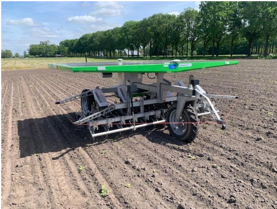
FarmDroid, autonome zaai en wiedrobot in de cichorei
