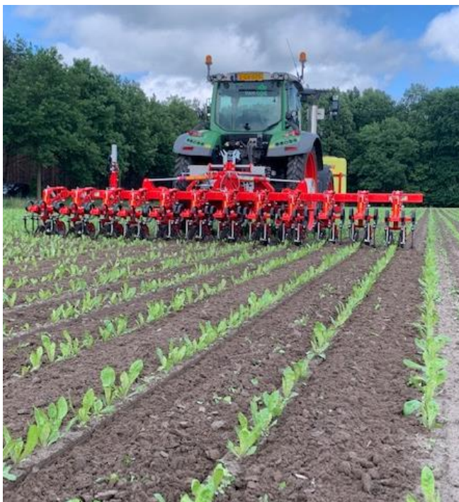
Camera gestuurde schoffelmachine
