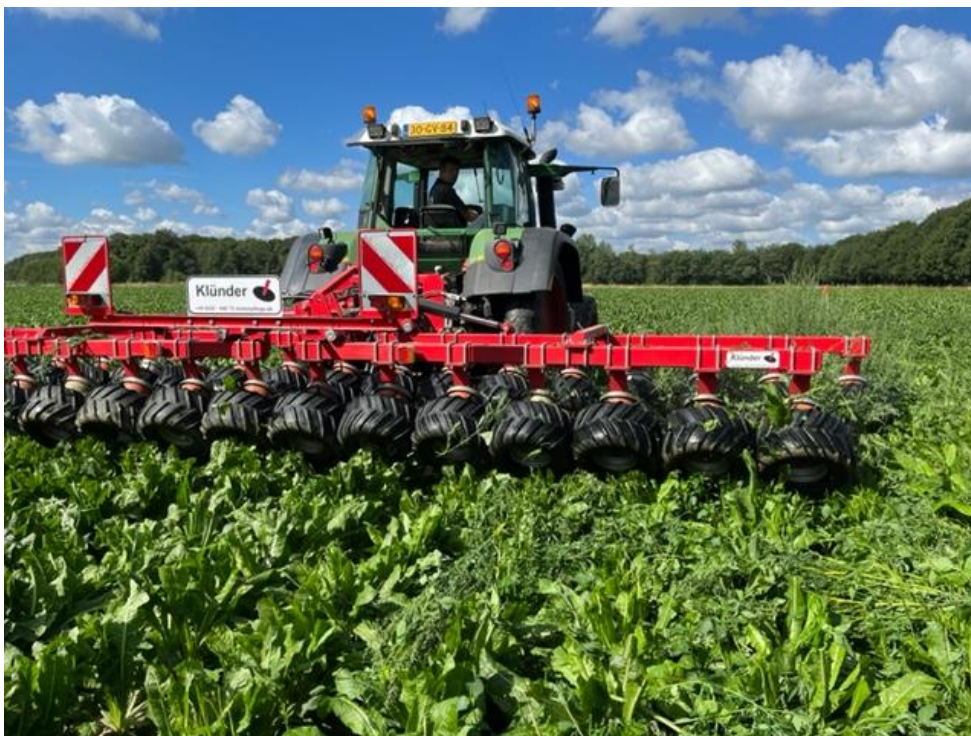
Klünder onkruidtrekker in de cichorei om grote meldes te verwijderen
