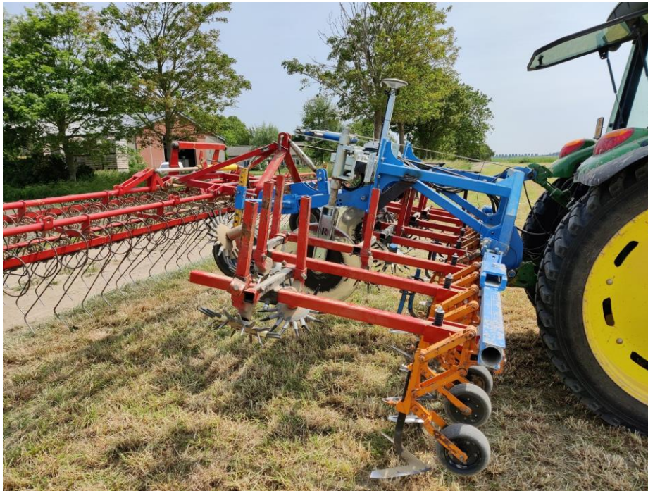
Foto: Een schoffel met RTK besturing, vingerwieders en een wiedeg
