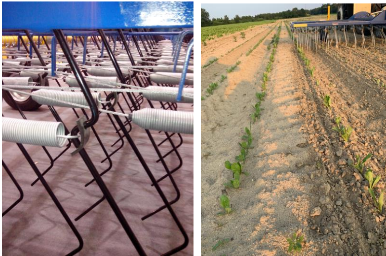
Foto Treffler met individueel geveerde tanden
